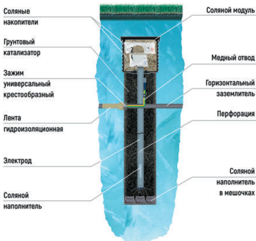
Рис. 6. Активный соляной электрод «Н-УДАВ» (вертикальное исполнение)
