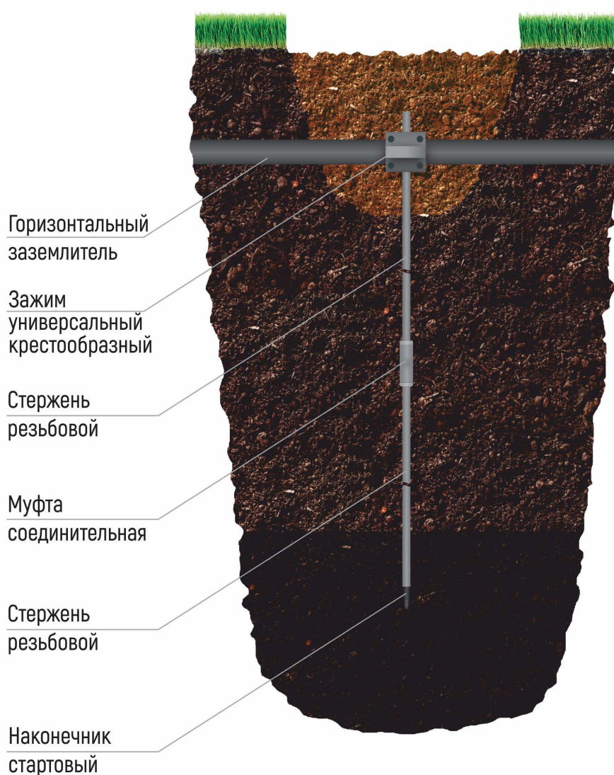
Рис. 8. Типовой глубинный электрод «КОБРА»
