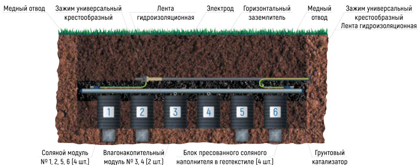
Рис. 7. Необслуживаемый активный соляной электрод «10 Ом»
