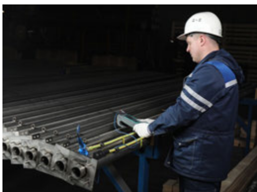
Приемо-сдаточные испытания: замеры переходного сопротивления «медный отвод – электрод»
