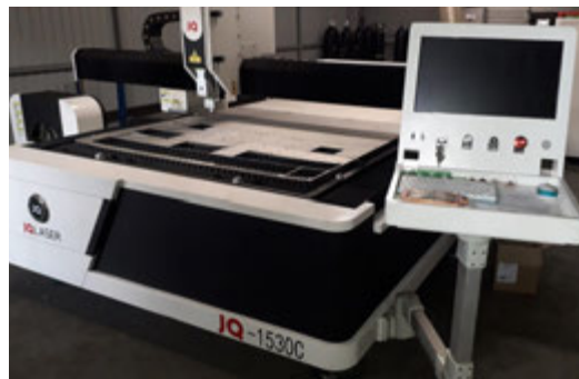
Изготовление деталей на лазерном станке (фланцев, приварных пластин)
