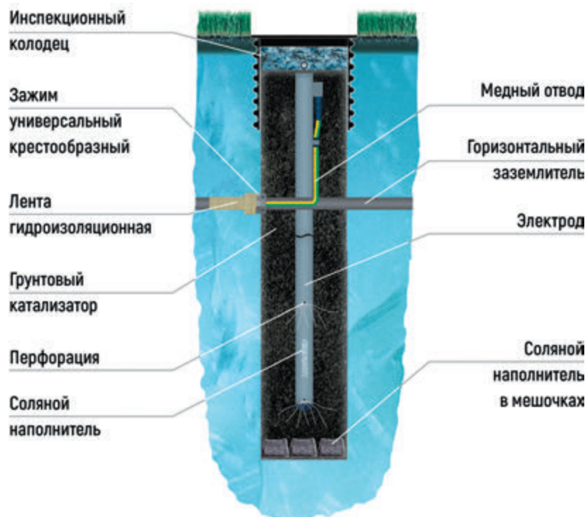
Рис. 2. Активный соляной электрод «УДАВ» (вертикальное исполнение)
