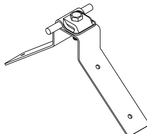
Прокладка прутка параллельно коньку кровли
