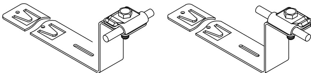
Прокладка прутка параллельно коньку кровли
